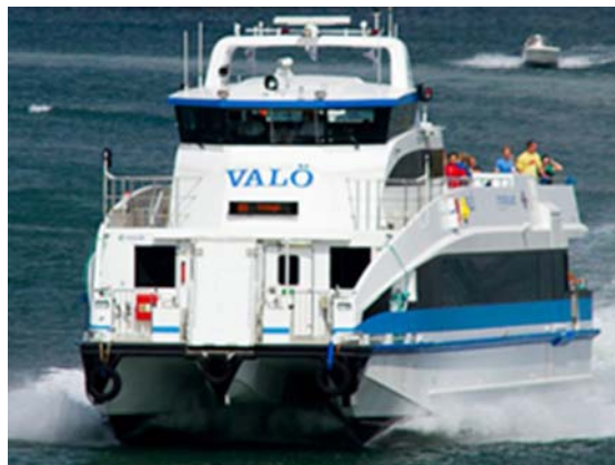
En av de två kolfiberkatamaraner som Styröbolaget anskaffat för trafiken i Södra skärgården
